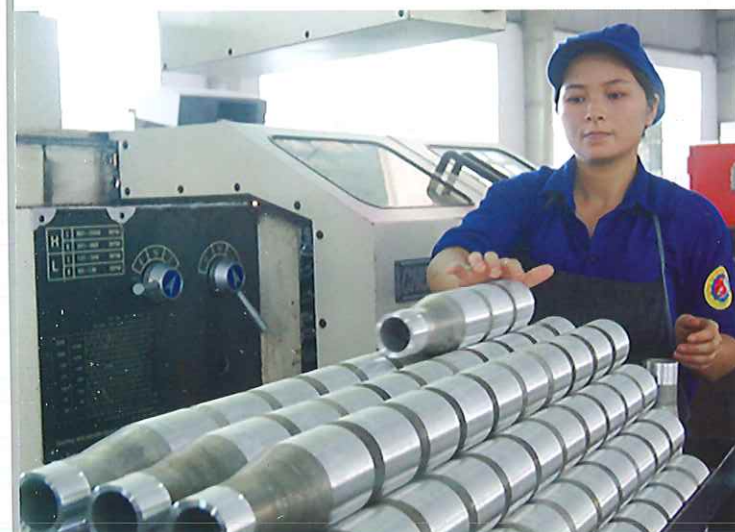
Công nhân viên quốc phòng nhà máy Z131 thực hiện phá lỗ thân đạn chống tăng B41 trên máy CNC.
